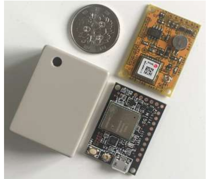
右上：GPS-TAB、右下：SGIM 左下：収納ケース（4 cm×3 cm×2 cm）
