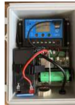
河川水位監視デバイス 防水対応 IP65
